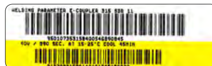
Abb. 39 – Schweiß- und Traceabilitycode von AGRU Heizwendelformteilen
